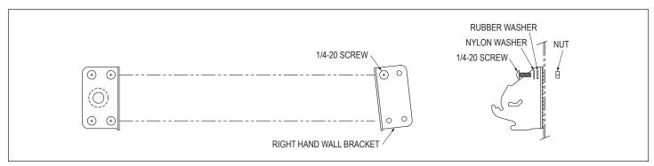
FIGURE 3 - FRONT VIEW AND SIDE VIEW OF RIGHT HAND WALL BRACKET
